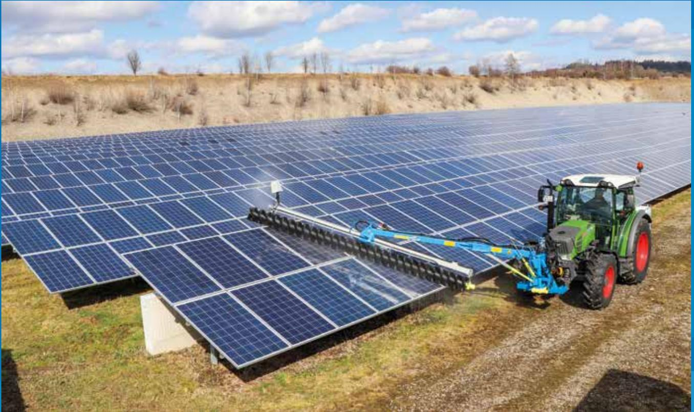
Com o sistema integrado de limpeza a úmido SunBrush® mobil, você obtém ótimos resultados no cuidado de sistemas de energia solar. Mesmo sujeira teimosa é removida suavemente. Com uma capacidade de limpeza de aproximadamente 7000 metros quadrados
